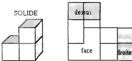
Contrairement à l'usage du dessin technique, on représente ici la vue de droite à droite de la vue de face, et la vue de dessus, au-dessus.
